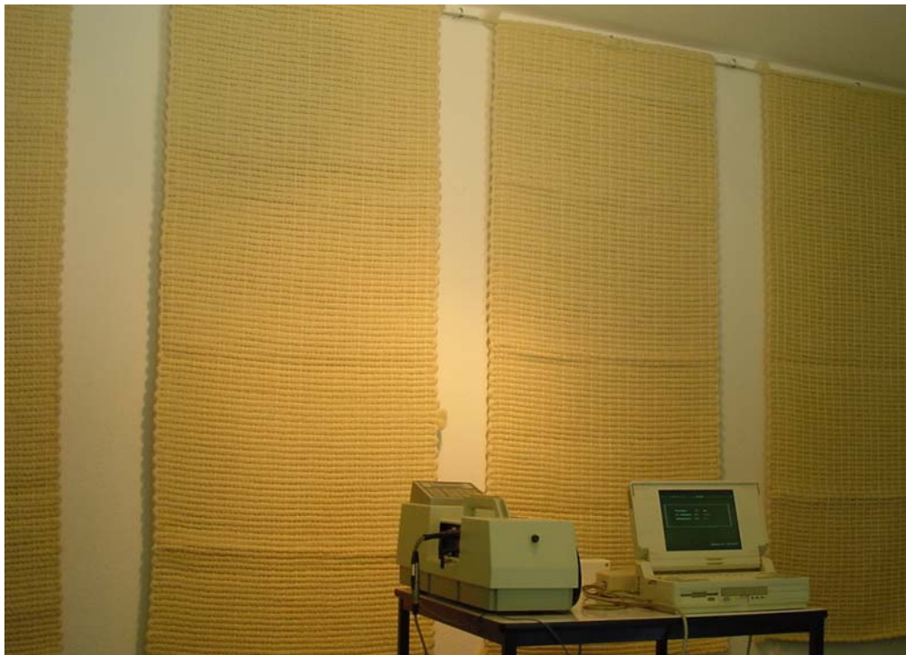
Abb. 2: Messanordnung zur Formaldehydmessung im Öko-Haus
